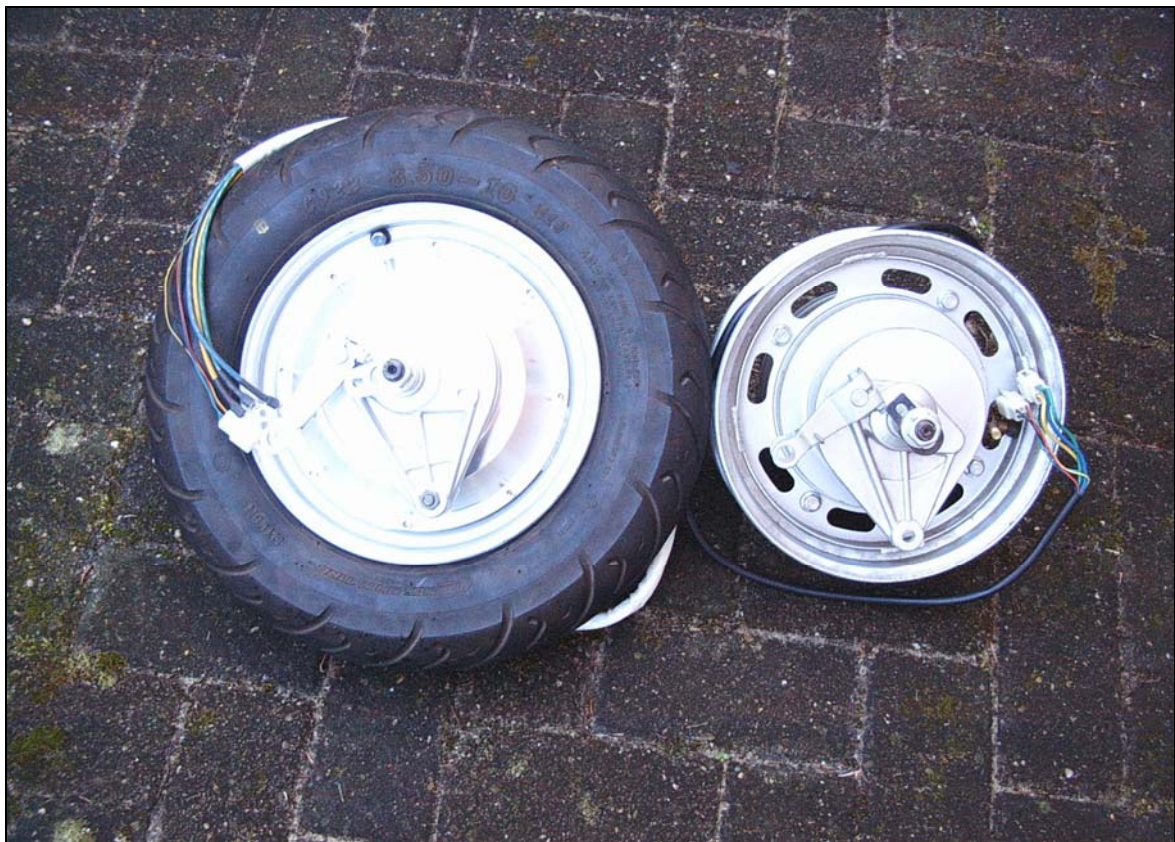
Neues und altes Hinterrad im Vergleich. Blick auf die Bremsanlage
